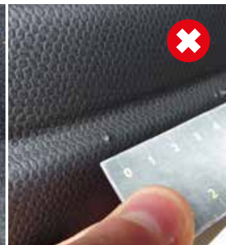
Rayure sensible à l'ongle ou arrachement de matière. Garniture cassée, percée, réparation de mauvaise qualité.
